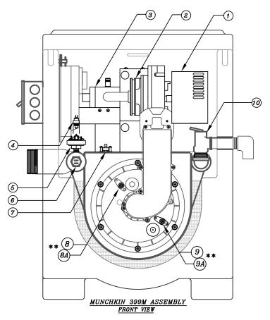
\*\* THE LOCATION OF THE HOT SURFACE IGNITOR AND FLAME RECTIFICATION PROBE IS REVERSED FOR ALL HA MODELS
